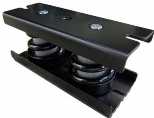
**Matériaux** Ressort avec traitement Shot peeling pour améliorer sa résistance dynamique et finition en époxy pour une meilleure protection. Polyéthylène assoupli a cellules fermées afin d'empêcher l'entrée d'éléments solides et éviter tout dommage sur les spires. Parties métalliques zinguées
