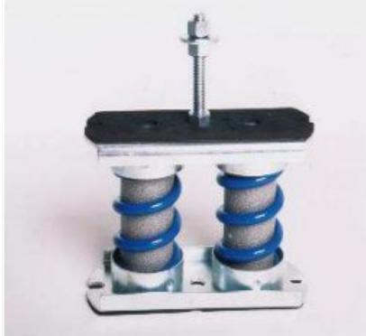
**Matériaux** Ressort avec traitement Shot peeling pour améliorer sa résistance dynamique et finition en époxy pour une meilleure protection. Polyéthylène assoupli à cellules fermées afin d'empêcher l'entrée d'éléments solides et éviter tout dommage sur les spires. Parties métalliques zinguées
