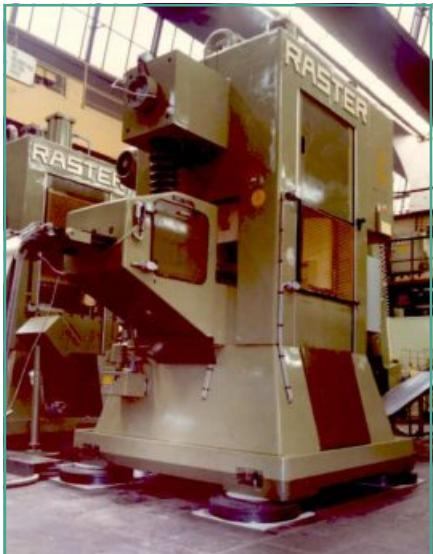
Les efforts engendrés par le fonctionnement de l'équipement installé sur isolateur doivent être pris en compte dans le calcul des supports et de leur implantation. Il faut, en effet, considérer deux états successifs : l'état statique où seules les masses sont retransmises aux supports et l'état dynamique où aux efforts précédents s'ajoutent les forces résultant du fonctionnement : poussée, couple de démarrage etc.
