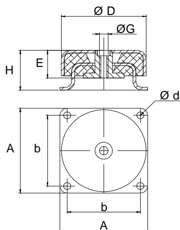
**Materials** Elastomer chloroprene CR double serie avec armature et coupelle en acier zingué
