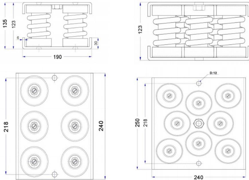
Hauteur libre 123 mm + Elastomère 5 mm 1 face Total 128 mm Sur demande Hauteur libre max 131 mm avec élastomère spécial 8 mm
