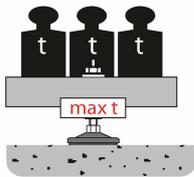
Vérifier que le poids par appui ne dépasse pas la capacité de charge du support
