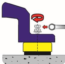
Baisser la machine puis visser le boulon jusqu'au contact puis procéder à la mise à niveau de **chaque** supports en vissant
